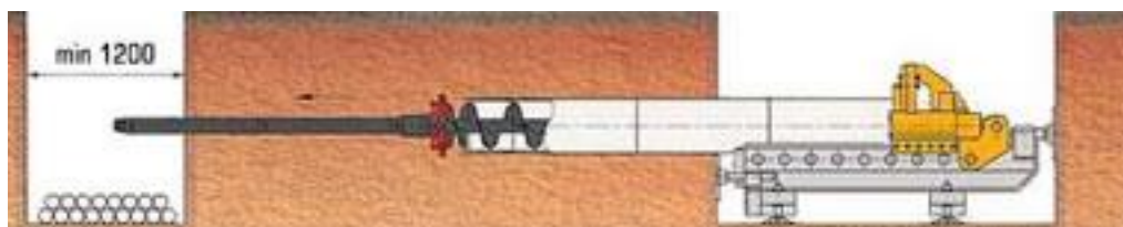
Ryc. 7. Etap II - przecisk hydrauliczny stalowych rur okładzinowych (źródło www.wamet.pl )
