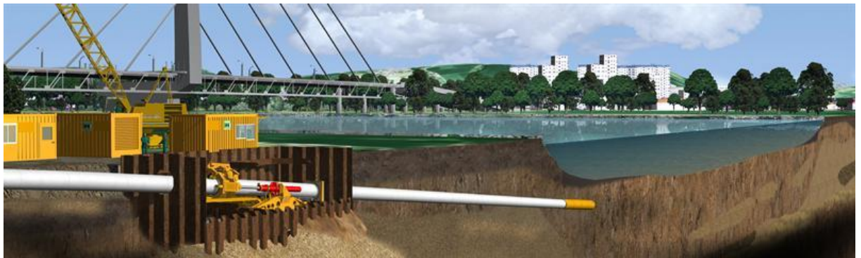
Ryc. 10. Metoda Direct Pipe - urządzenie pchające zainstalowane w komorze (źródło Herrenknecht)
