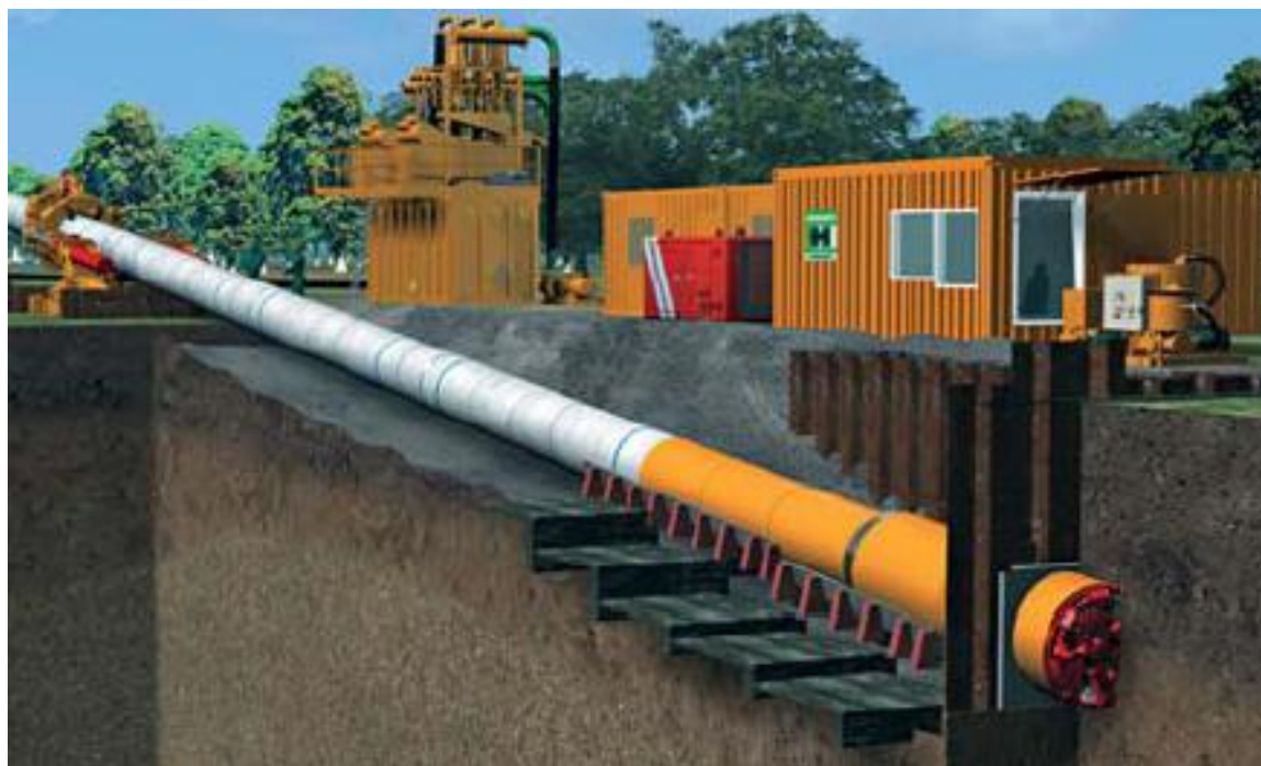
Ryc. 9. Metoda Direct Pipe - widok głowicy mikrotunelowej (źródło Herrenknecht )
